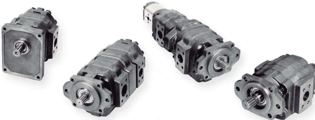
Se trata de un conjunto de bombas y motores de engranajes denominado **línea pesada**, que abarca caudales de 215 / 250 / 280 / 315 / 345 / 380 lts/min a 2000 rpm y presiones hasta 190 bar.
